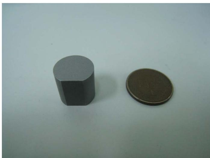
圖 10. 醫療級鈦合金(Ti-6Al-4V ELI)加工實驗前之實際外觀
