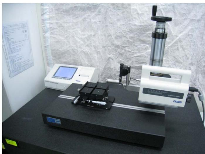
圖 7. SURFCOM 130A表面粗糙度量測儀
