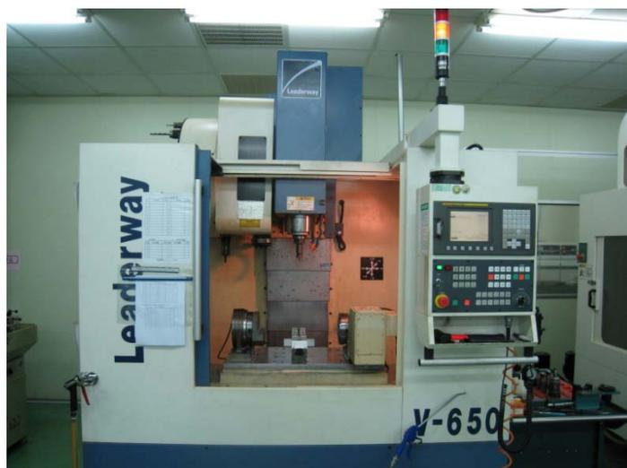
圖 6. LEADERWAY-V650 CNC三軸切削加工機
